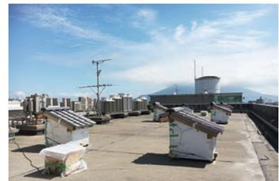
図10：試験体を用いた瓦屋根の熱性能の検証
