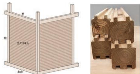
図1：角材を平積みしたログパネルによるマスティンパー
