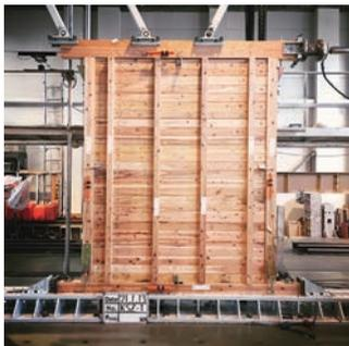
図4：壁倍率認定へ向けた性能評価試験の様子
